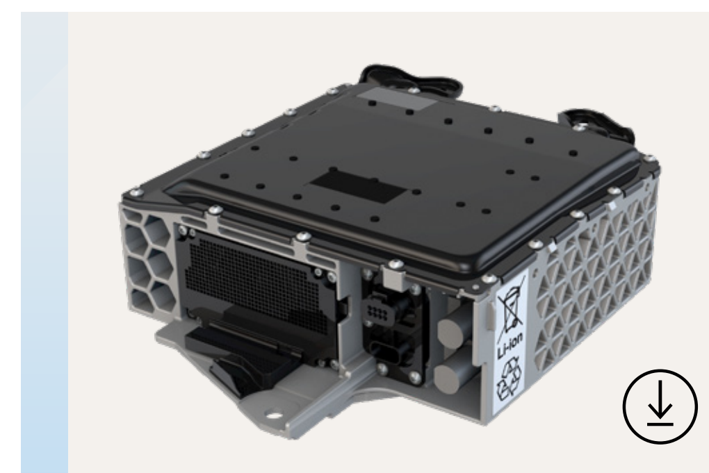
Die 48V-Batterie des eTSI
